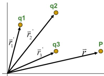
Misalkan muatan sumber terdiri atas 3 muatan titik  $q_1$ ,  $q_2$  dan  $q_3$ . Gaya resultan pada muatan uji  $q'$  pada titik P adalah superposisi gaya pada  $q'$  oleh masing-masing muatan sumber. Bila kuat medan pada titik P (vektor posisi) oleh  $q_1$  saja adalah  $\vec{E}_1(\vec{r})$ , dan kuat medan oleh  $q_2$  saja adalah  $\vec{E}_2(\vec{r})$ , dan oleh  $q_3$  saja adalah  $\vec{E}_3(\vec{r})$ , kuat medan resultan pada titik P adalah :
